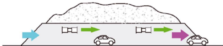
Figura 6 Ventilación longitudinal Fuente: PIARC
